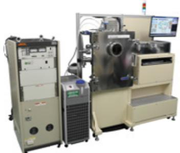
成膜レシピ制御型自動蒸着装置
